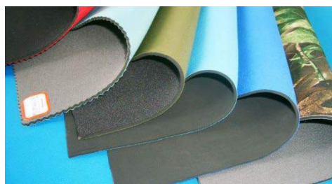
Рисунок 1 – Структура и внешний вид неопрена
